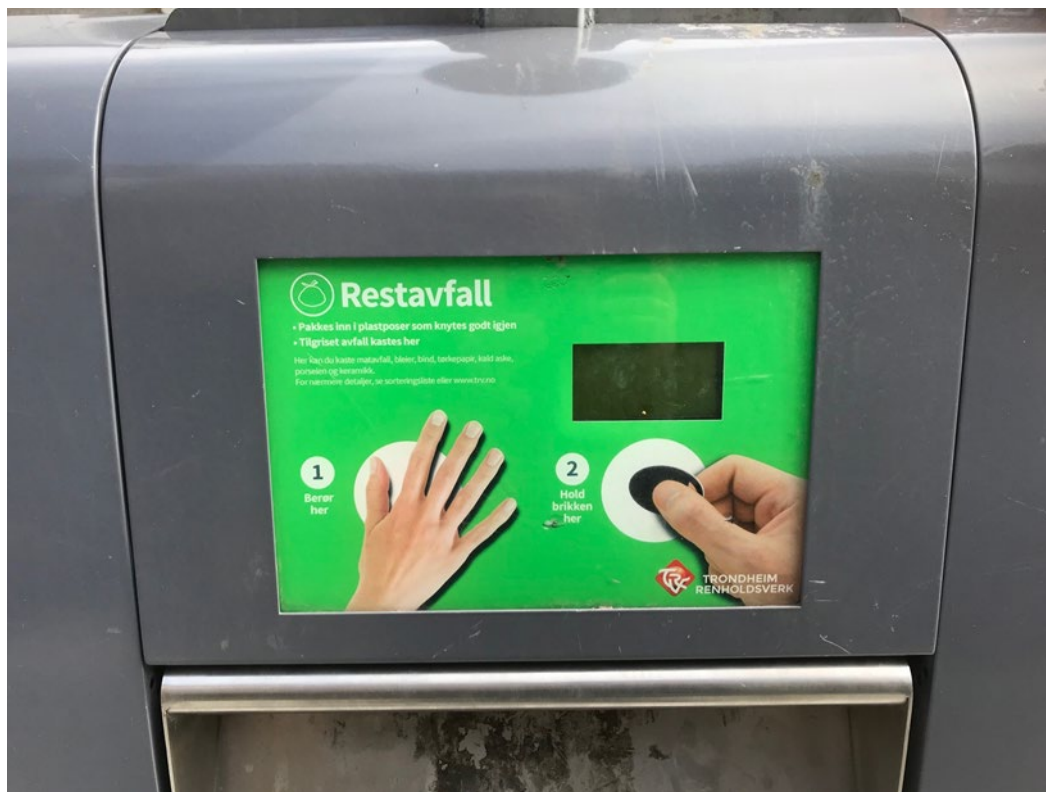
Figur 7: RFID for kontroll med hvem som bruker oppsamlingsenhetene. Her fra fellesløsning (overflatecontainer) i Trondheim. (Foto: Anne Kristin Holen, Multiconsult)
